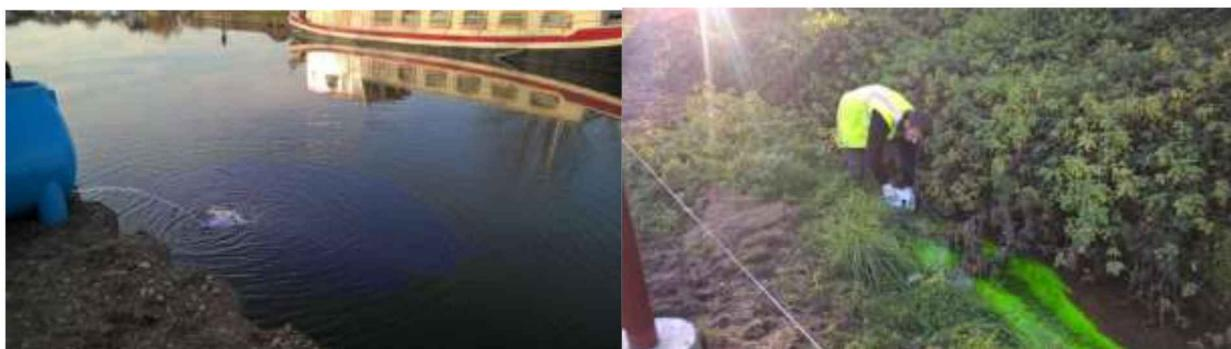
Photo n° 1 : Injection du naphthionate (à gauche) et de la fluorescéine (à droite)
